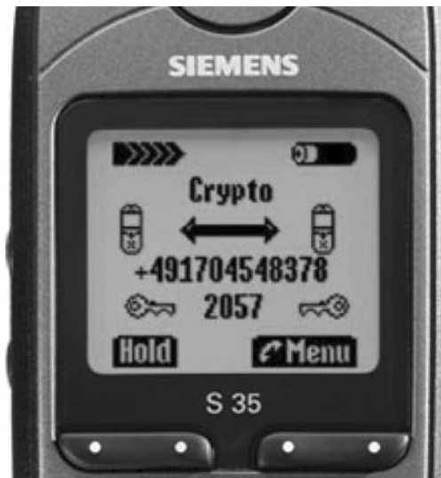
Bild 82: Das Display des TopSec GSM zeigt ein verschlüsseltes Gespräch an
